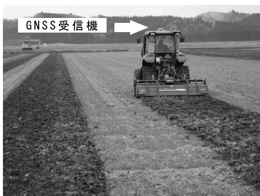
図-3 自動操舵システムを利用した 行程空け耕うん作業の状況
