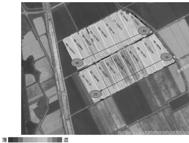
図－8 ドローンに搭載したマルチスペクトルカメラにより撮影したNDVIマップ
