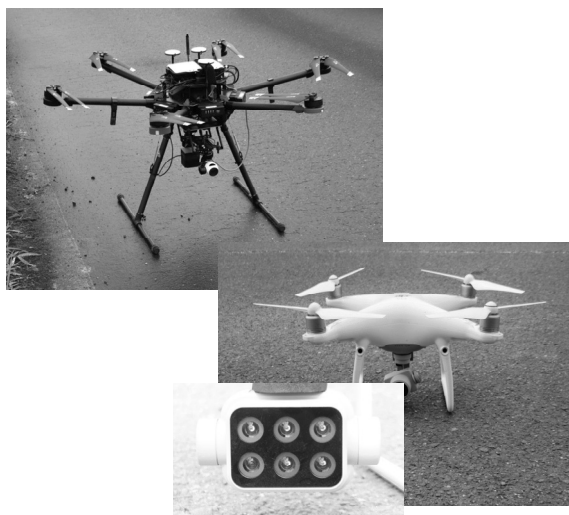
図－7 センシング用ドローンとマルチスペクトルカメラ
